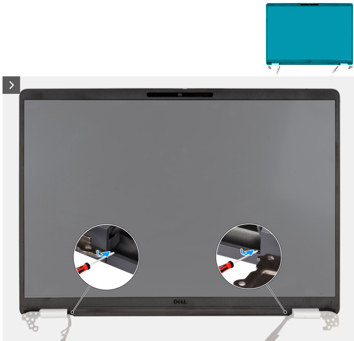
Obrázek 59. Uvolnění plastového čelního krytu
