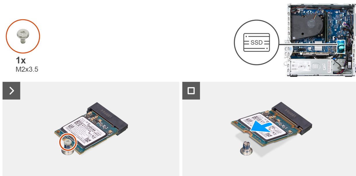
Obrázek 22. Demontáž disku SSD M.2 2230
