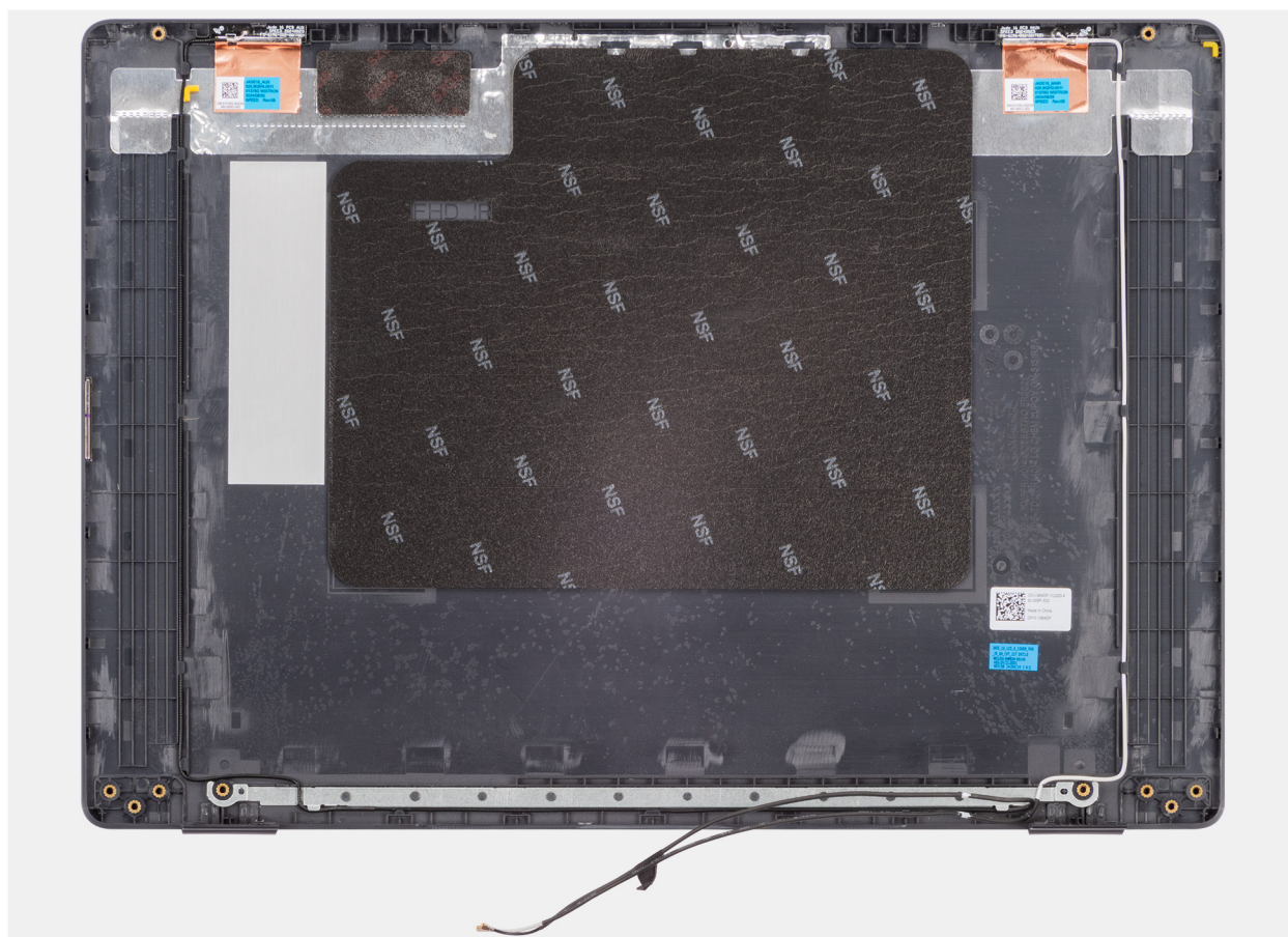
Obrázek 117. Demontáž sestavy zadního krytu displeje
