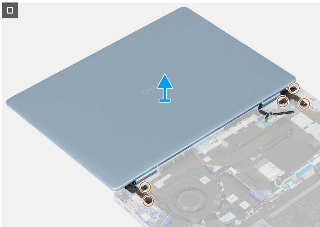
Obrázok 26. Demontáž zostavy obrazovky 2
