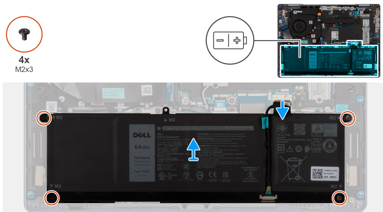
Obrázok 15. Demontáž batérie
