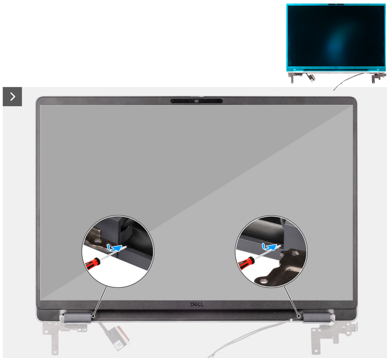
Obrázek 98. Demontáž čelního krytu displeje
