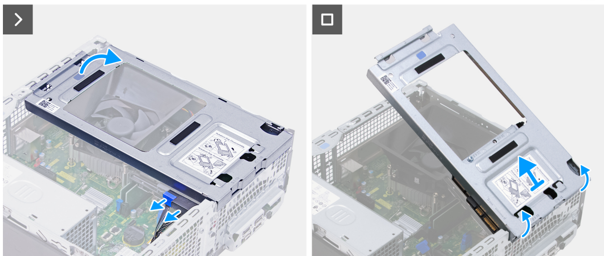
Obrázek 18. Demontáž diskové pozice
