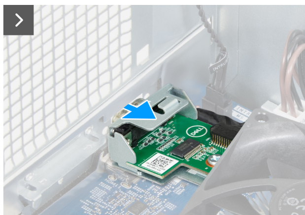
Obrázek 45. Demontáž modulu sériového portu
