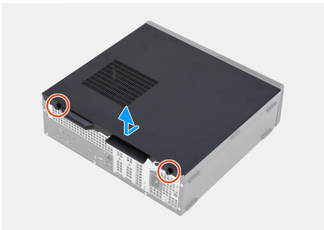
Obrázek 10. Demontáž levého bočního krytu
