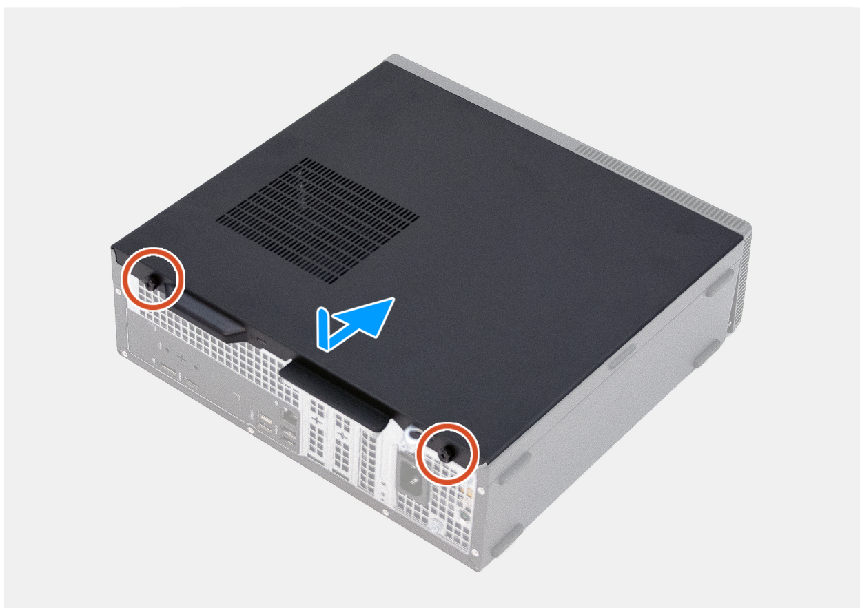
Obrázek 11. Montáž levého bočního krytu
