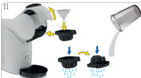
Vyjměte nádobu. Vyprázdněte a vyčistěte nádobu. Vytáhněte držák kapslí. Vyjměte proplachovací nástroj. Uchovejte jej na bezpečném místě pro pozdější čištění nebo odvápnění. Obě strany držáku kapslí opláchněte čerstvou pitnou vodou. Opět vložte držák kapslí.
