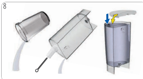
Vyprázdněte a vyčistěte nádobu. Vypláchněte a vyčistěte zásobník vody. V případě potřeby použijte čistý, biologicky bezpečný kartáč a mycí prostředek. Zásobník vody znovu naplňte čerstvou pitnou vodou a vložte jej do přístroje. Nádobu vložte pod výpusť nápoje.
