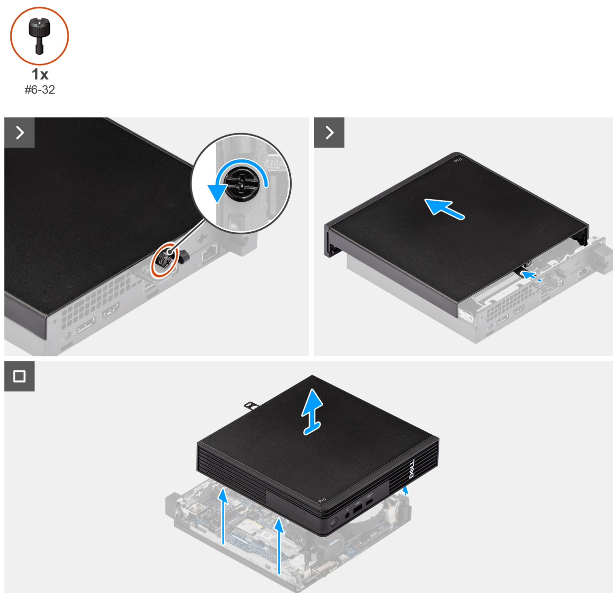
Obrázek 10. Demontáž bočního krytu
