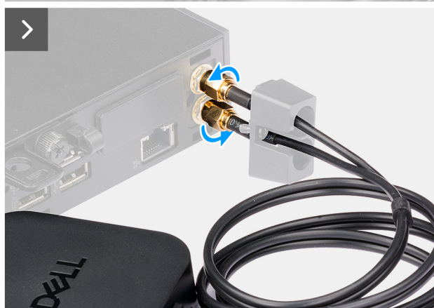
Obrázek 34. Demontáž externí antény
