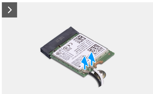
Obrázek 26. Demontáž bezdrátové karty
