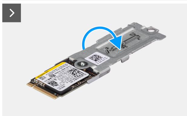
Obrázek 16. Demontáž disku SSD 2230
