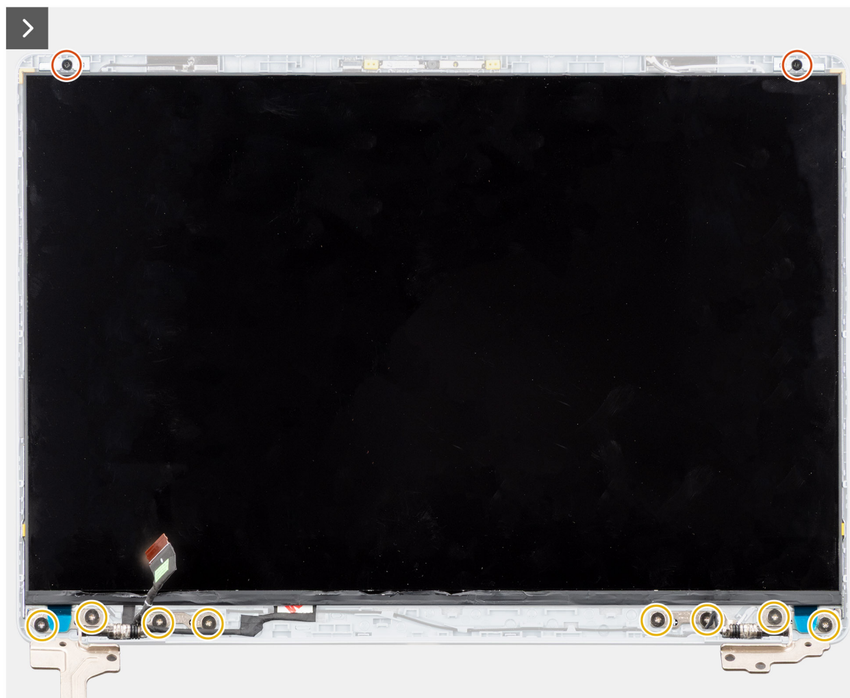
Obrázek 61. Demontáž obrazovky displeje
