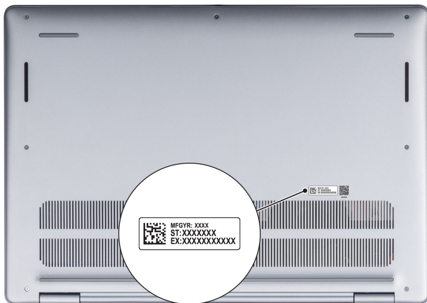
Obrázek 7. Umístění výrobního čísla / kódu Express Service Code
