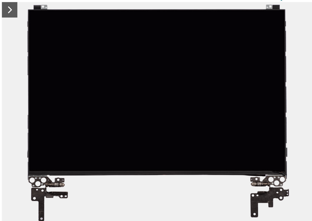
Obrázok 109. Montáž zostavy zobrazovacieho panela
