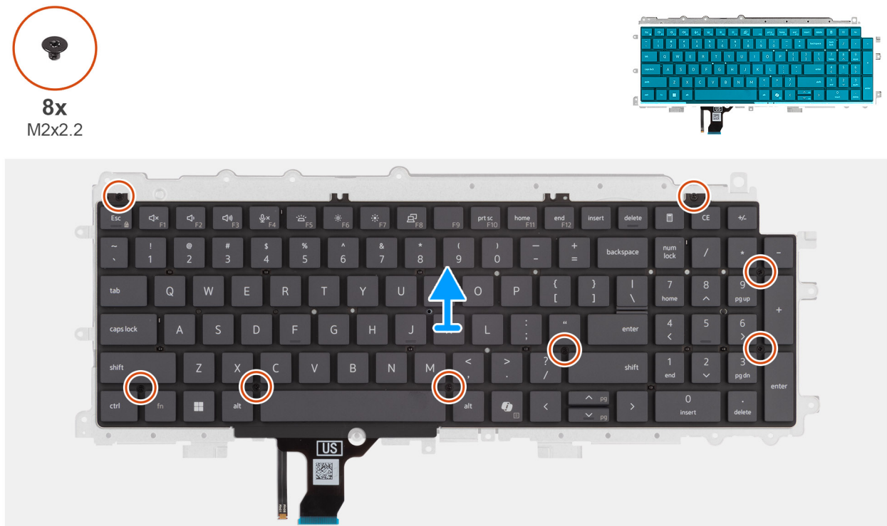
Obrázok 85. Demontáž opornej podložky klávesnice
