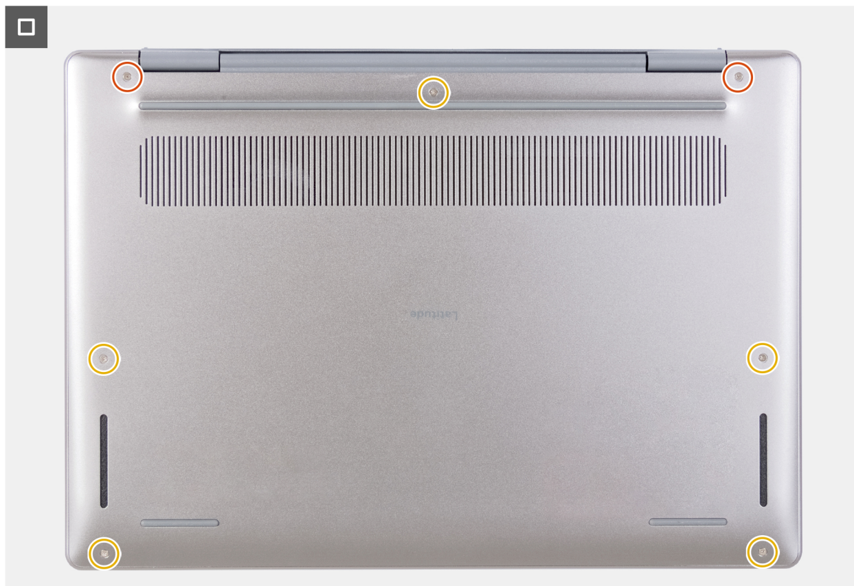
Obrázek 21. Zašroubování a utažení šroubů
