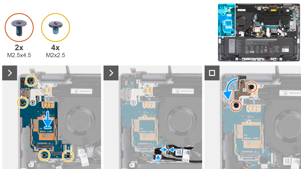
Obrázek 86. Montáž desky I/O, demontáž desky I/O (pro počítače dodávané s podporou sítě WWAN)
