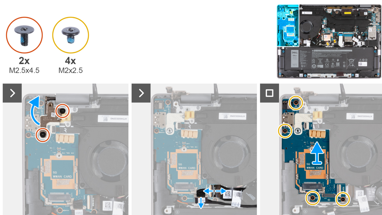
Obrázek 85. Demontáž desky I/O (pro počítače dodávané s podporou sítě WWAN)
