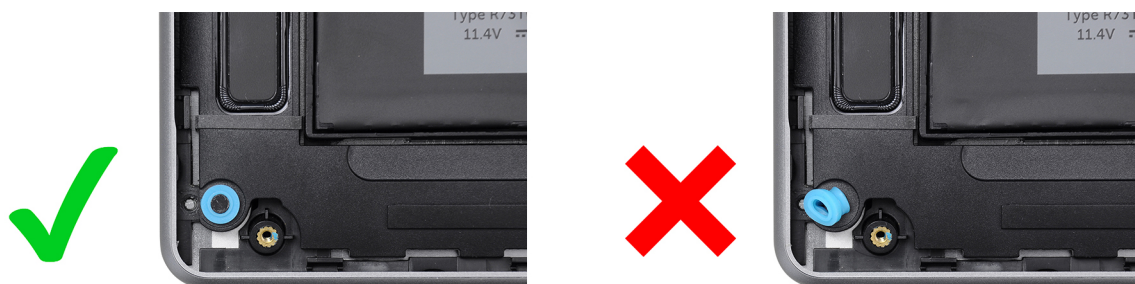
Obrázek 35. Montáž pryžových průchodek
