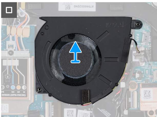
Obrázek 38. Demontáž ventilátoru (pro počítače dodávané s podporou sítě WWAN)
