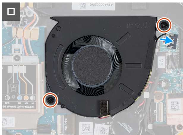
Obrázek 39. Montáž ventilátoru (pro počítače dodávané s podporou sítě WWAN)
