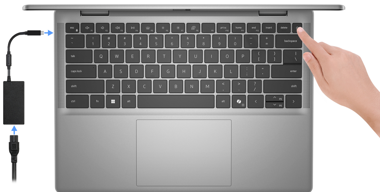
Obrázek 7. Připojte napájecí adaptér a stiskněte vypínač
