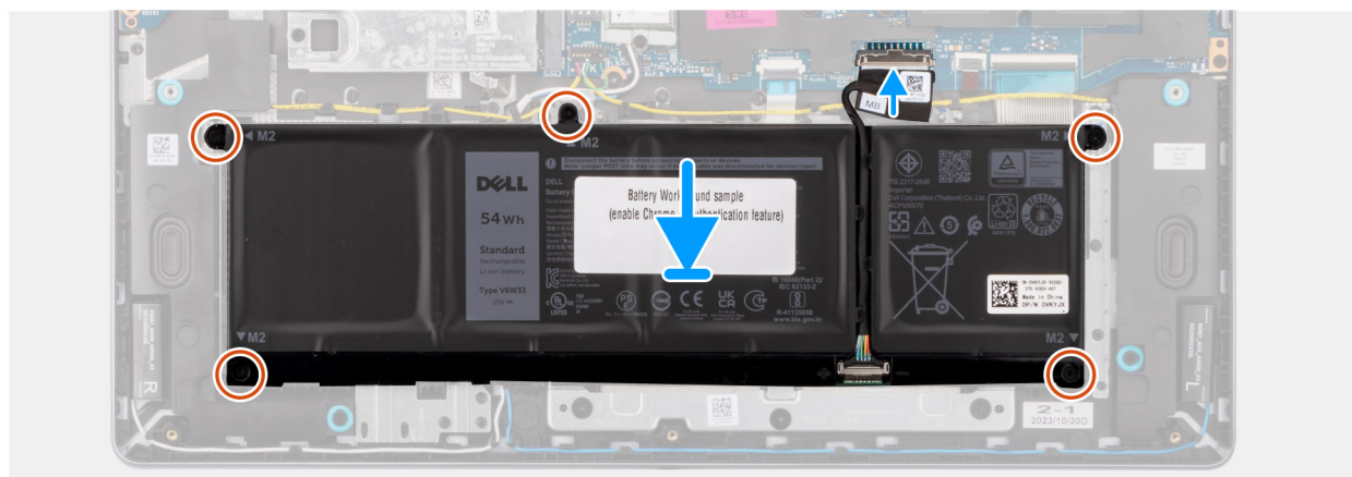
Obrázek 20. Montáž 4článekové baterie
