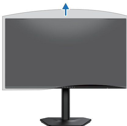
Obrázek 15. Zvedněte ochranný kryt z monitoru.
