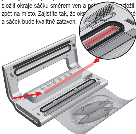
Obrázek 4: Během procesu vakuového balení musí být okraj sáčku ve středu vakuového kanálku.
