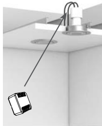
montáž do podhledu
