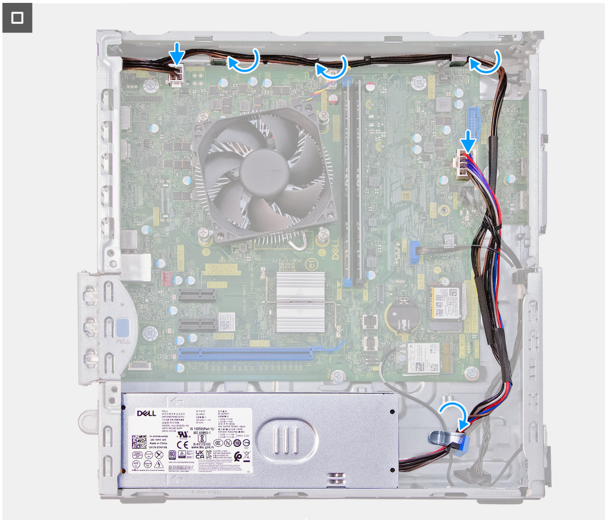
Obrázok 36. Montáž napájacieho zdroja
