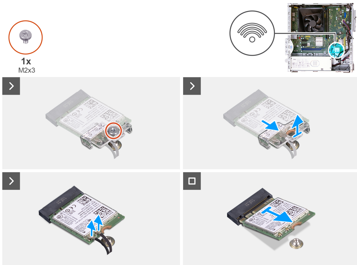
Obrázok 27. Demontáž karty bezdrôtovej komunikácie
