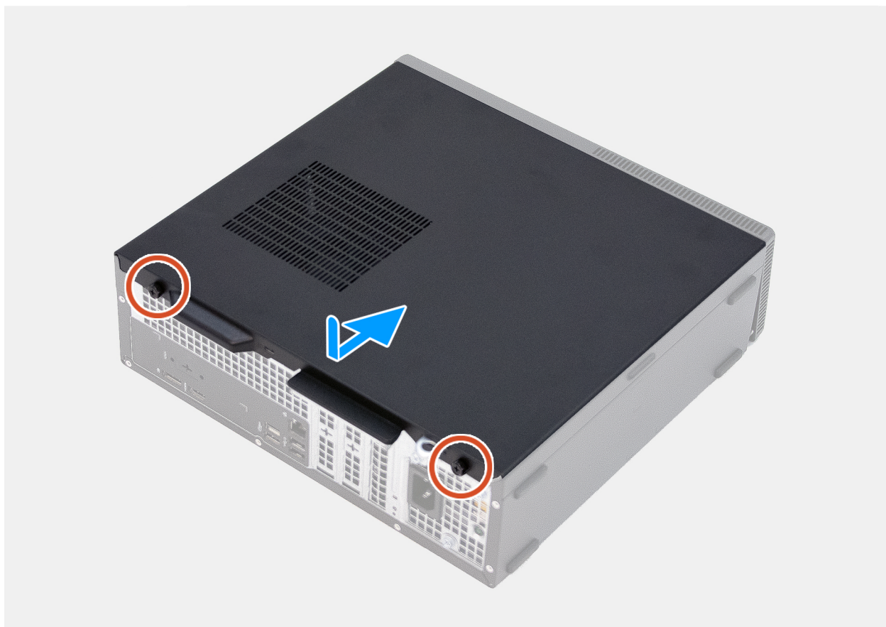
Obrázok 12. Montáž ľavého bočného krytu
