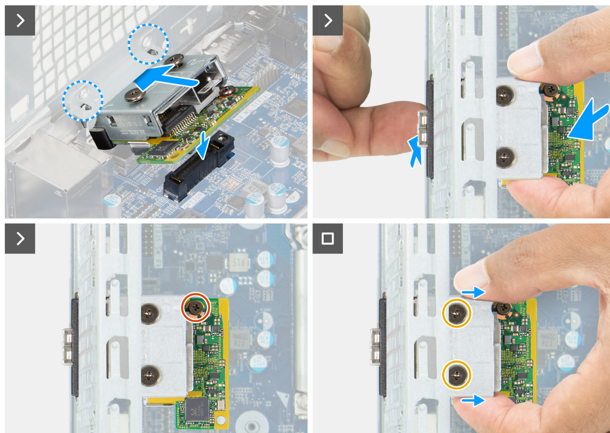
Obrázek 80. Montáž modulu portu optického vlákna
