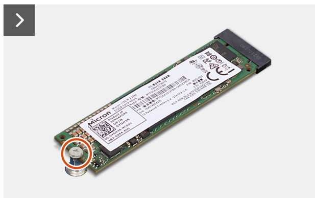
Obrázek 31. Demontáž disku SSD M.2 2280 ze slotu 0
