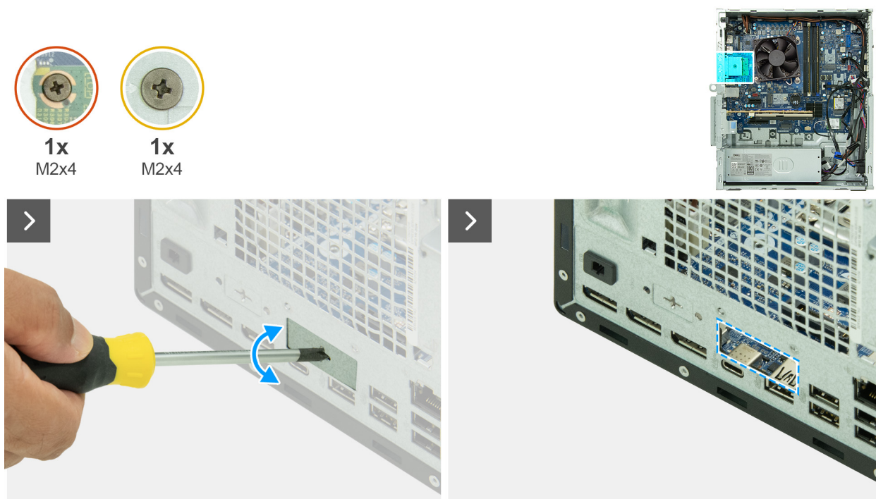
Obrázek 76. Montáž modulu volitelného portu
