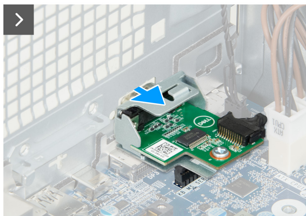
Obrázek 81. Demontáž modulu sériového portu
