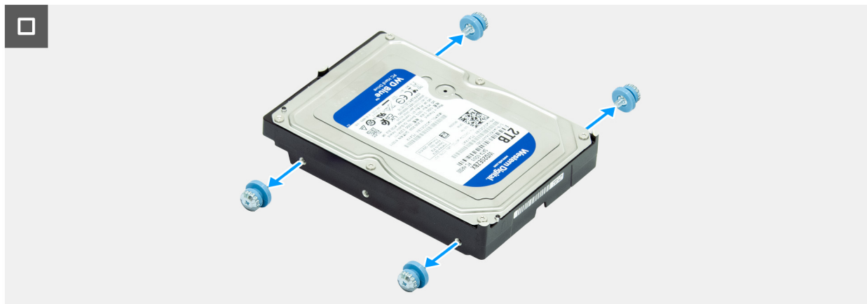
Obrázek 63. Demontáž pevného disku
