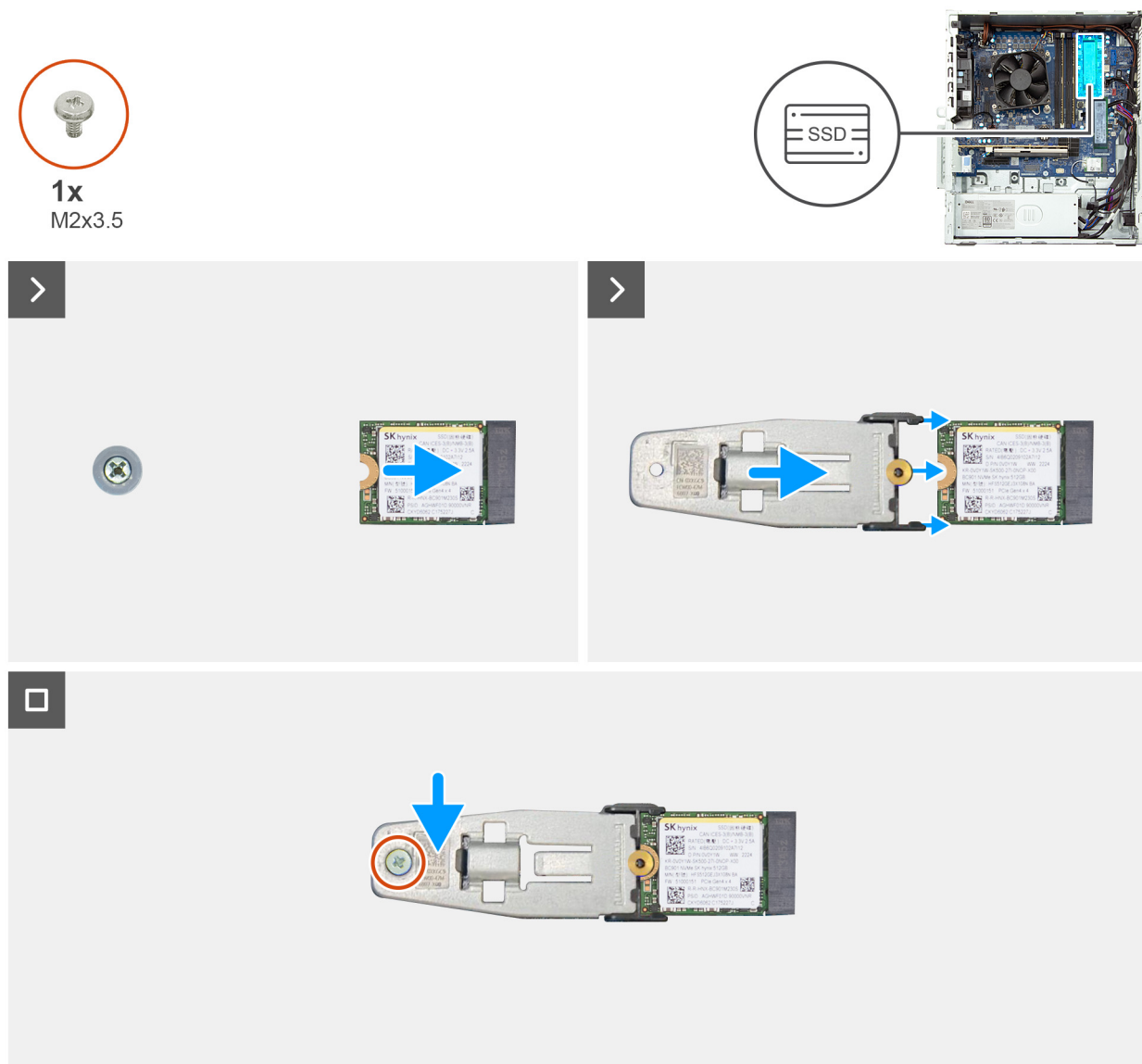
Obrázek 37. Montáž disku SSD M.2 2230 do slotu č. 2
