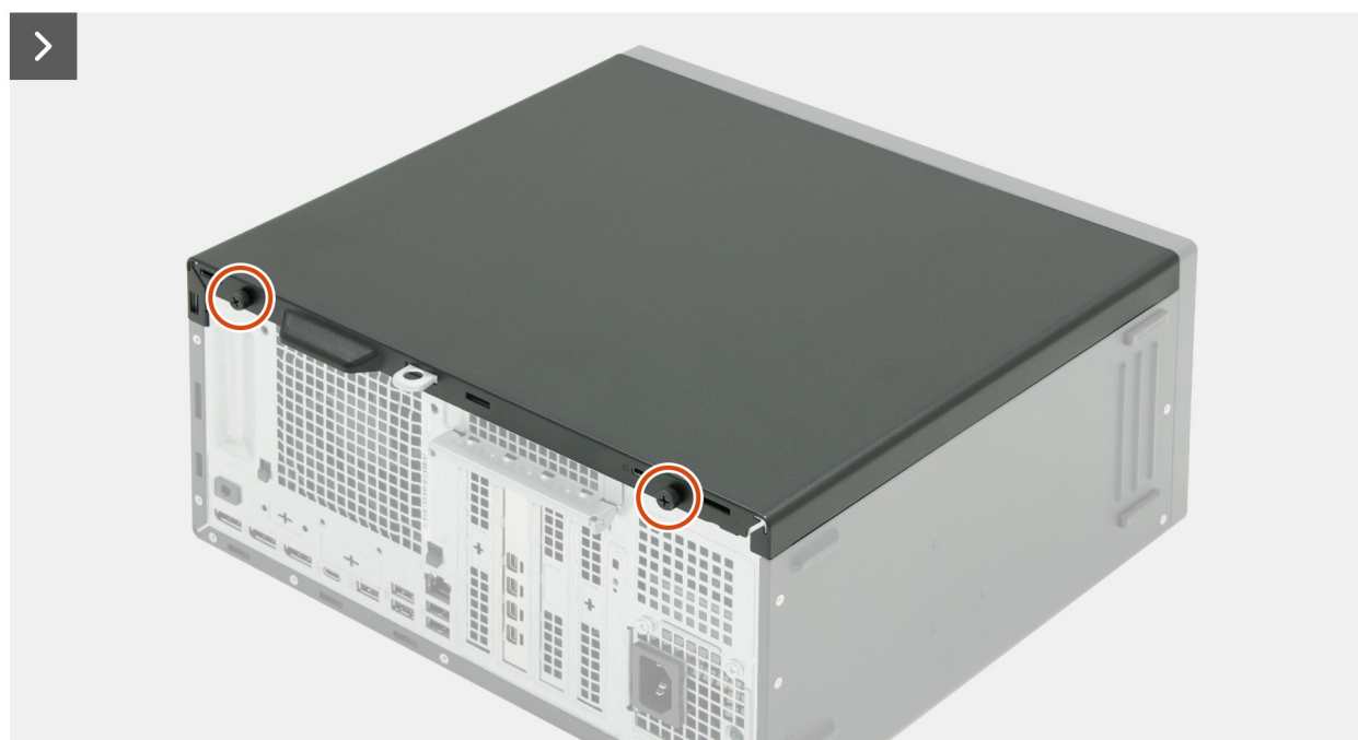
Obrázek 13. Demontáž levého bočního krytu
