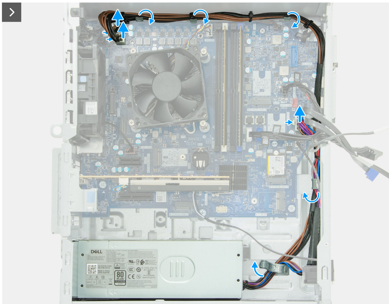
Obrázek 88. Demontáž napájecího zdroje
