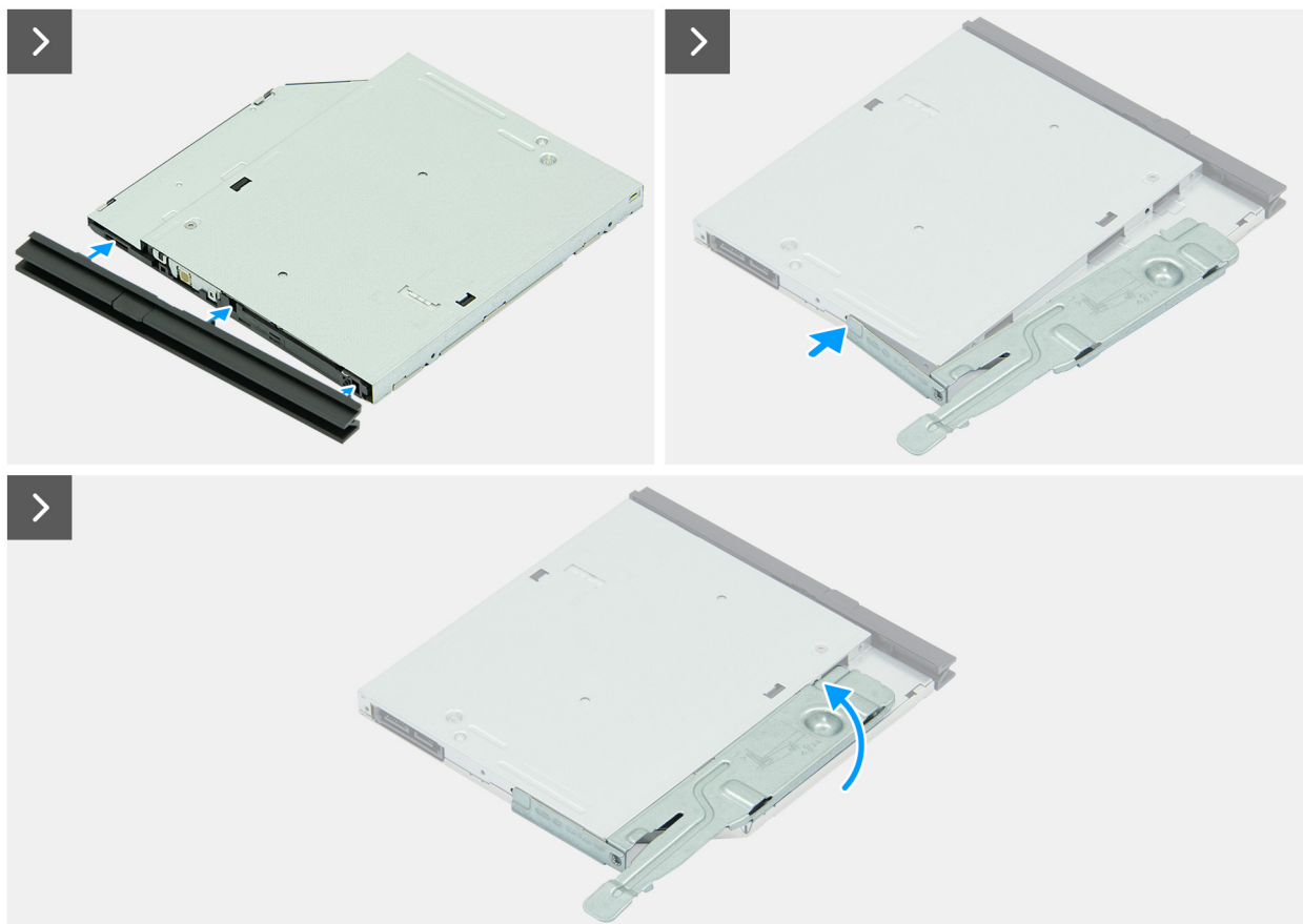
Obrázek 56. Montáž optické jednotky
