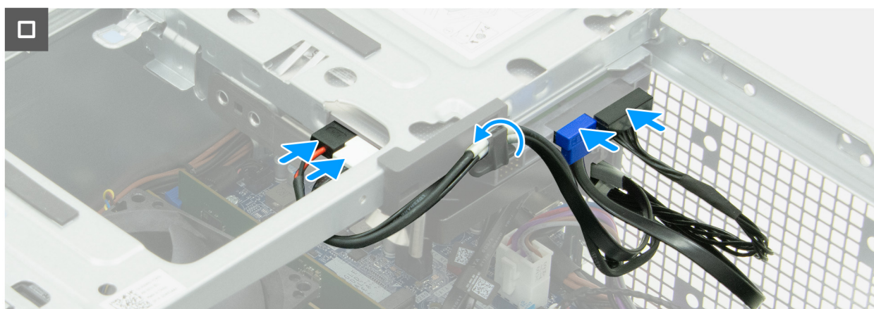
Obrázek 62. Montáž diskové pozice
