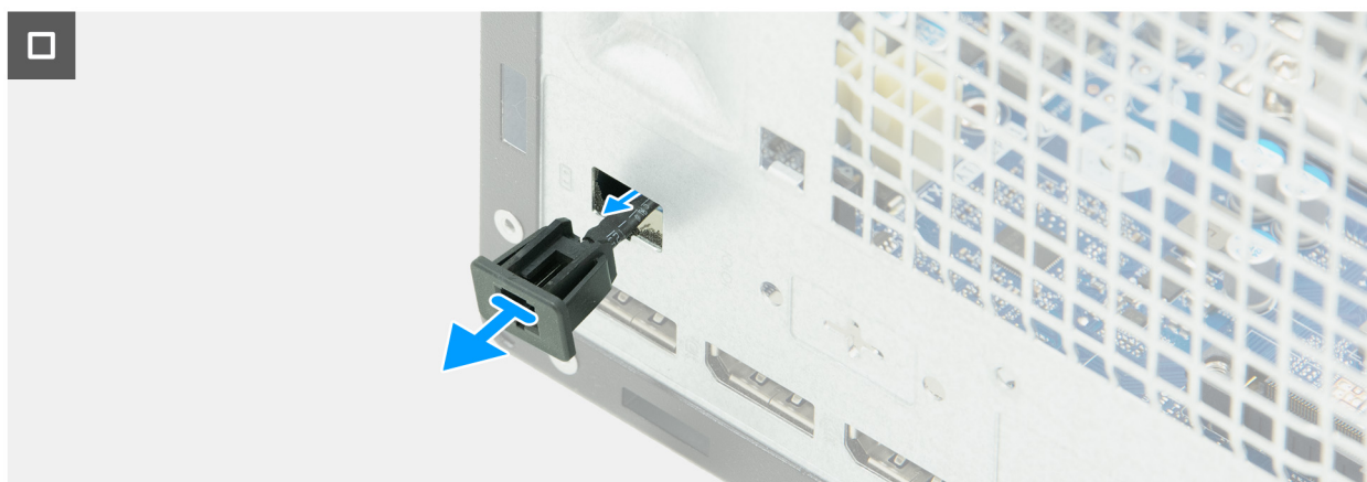
Obrázek 70. Demontáž kabelu dálkového vypínače napájení
