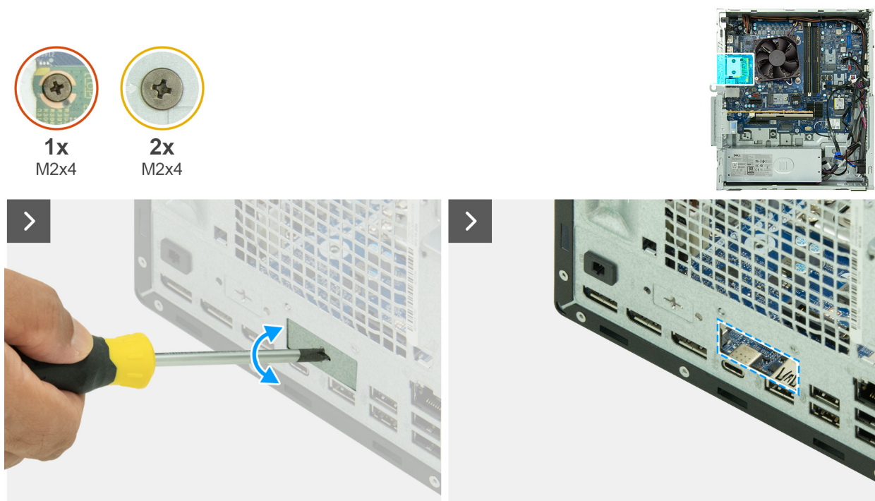
Obrázek 79. Montáž modulu portu optického vlákna
