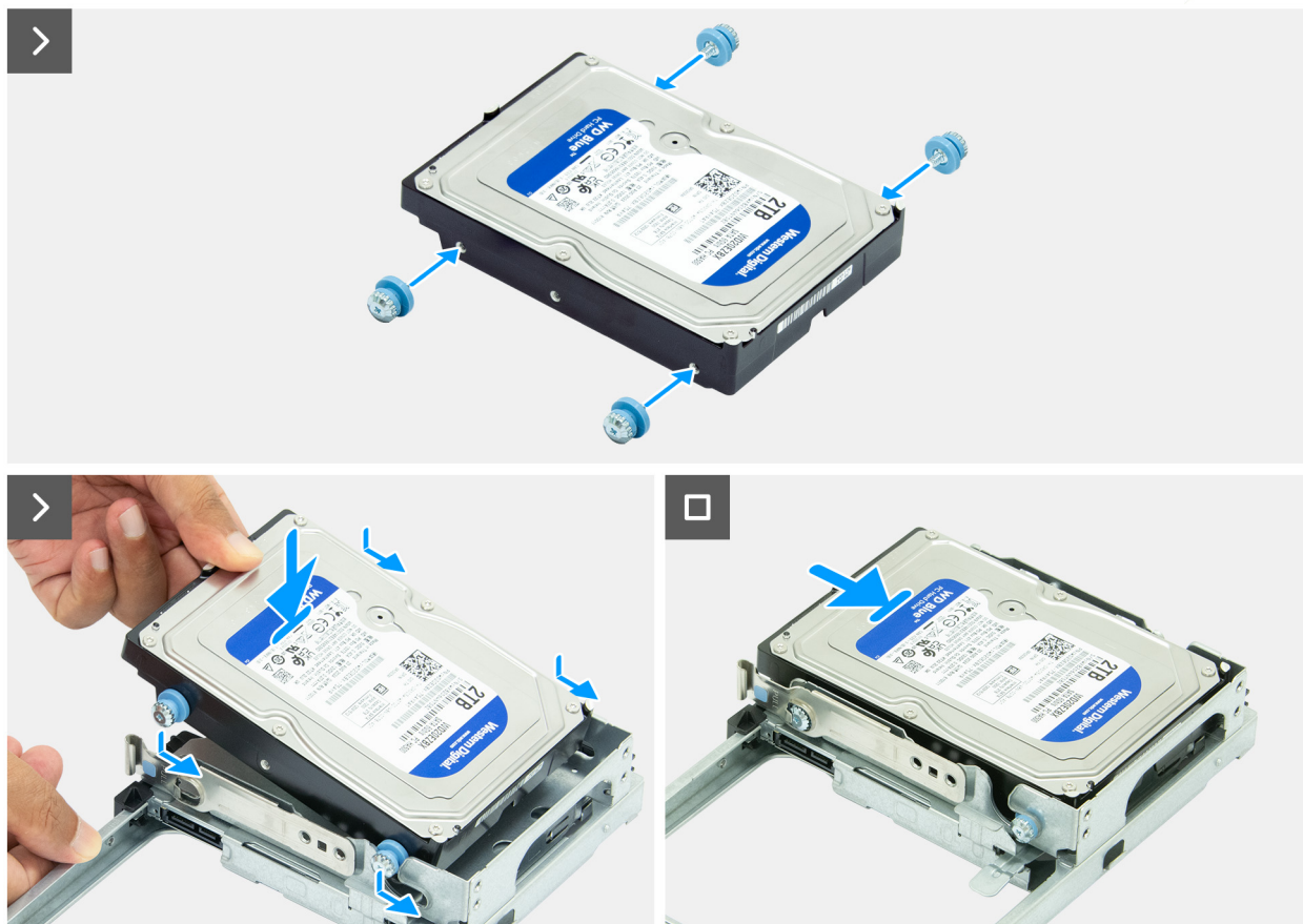
Obrázek 64. Montáž pevného disku
