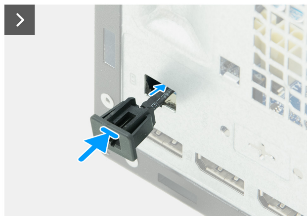
Obrázek 71. Montáž kabelu dálkového vypínače napájení
