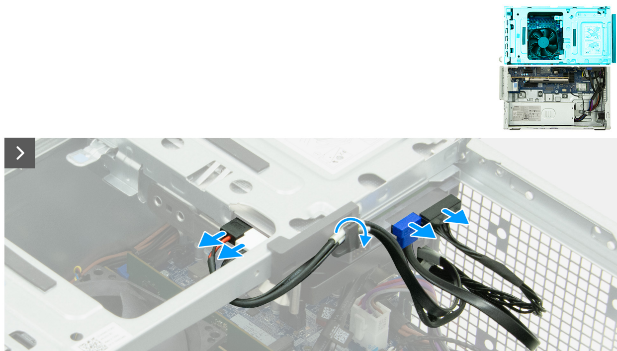
Obrázek 58. Demontáž diskové pozice
