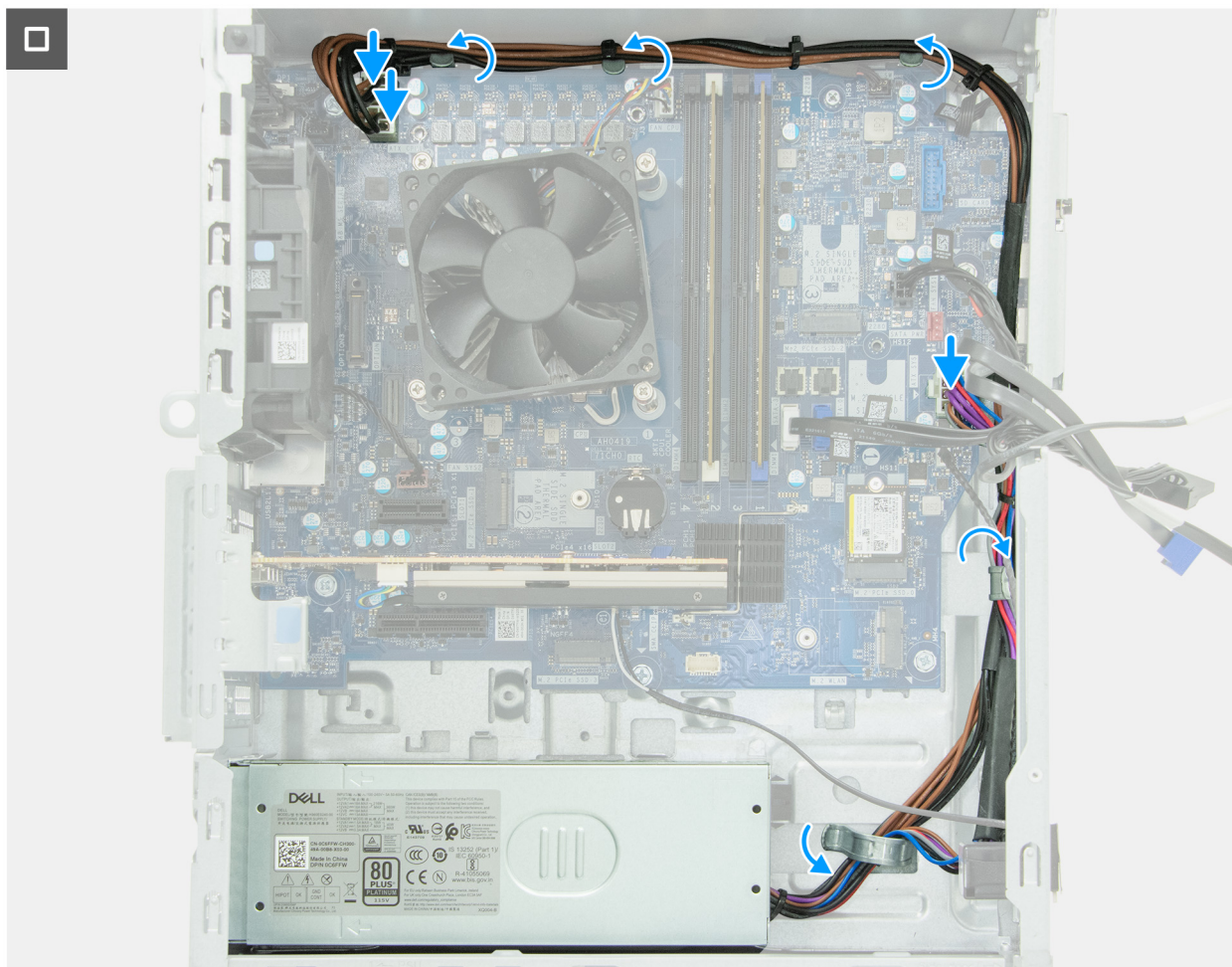
Obrázek 91. Montáž napájecího zdroje
