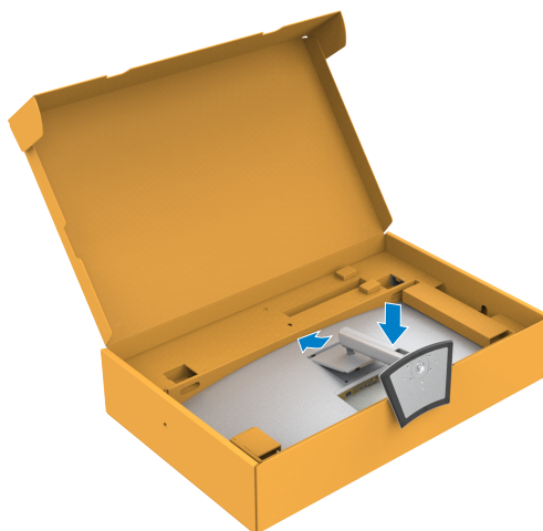
Obrázek 16. Zasuňte výstupky na zvedáku stojanu do otvorů
