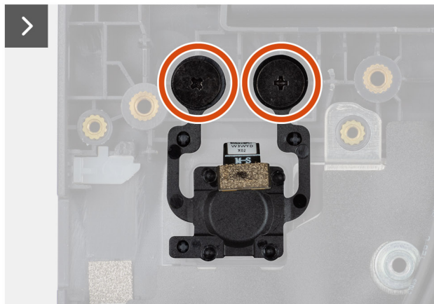
Obrázek 40. Demontáž vypínače se čtečkou otisků prstů
