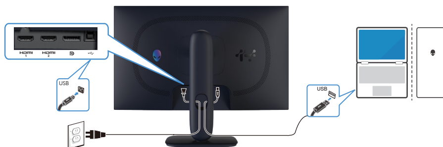
Figure 30. Připojení kabelu USB Type-B (Type-B na Type-A).
