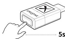
Halten Sie die *Bluetooth*-Taste 5 Sekunden lang gedrückt, um einen Master-Reset durchzuführen. Die LED-Anzeige beginnt rot zu blinken. Der Audiosender kehrt nach Abschluss in seinen Standardzustand zurück.
