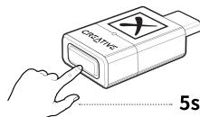
ブルートゥース ボタンを5秒長押ししてマスター リセットを実行します。LED インジケーターが赤点灯を始めます。完了するとオーディオトランスマッターがデフォルトの状態に戻ります。
