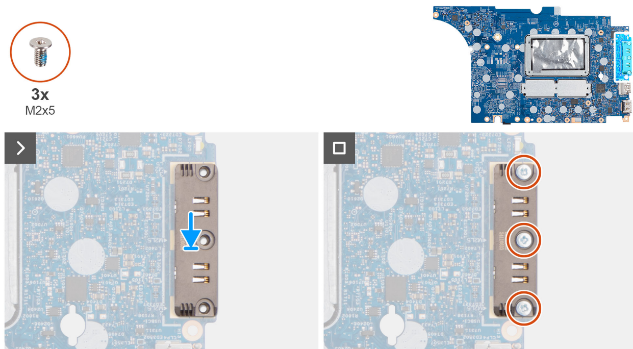
Obrázek 93. Montáž modulu USB Type-C
