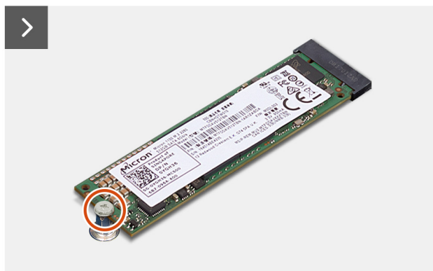
Obrázek 31. Demontáž disku SSD M.2 2280
