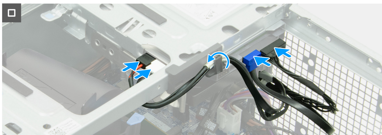
Obrázek 45. Montáž diskové pozice
