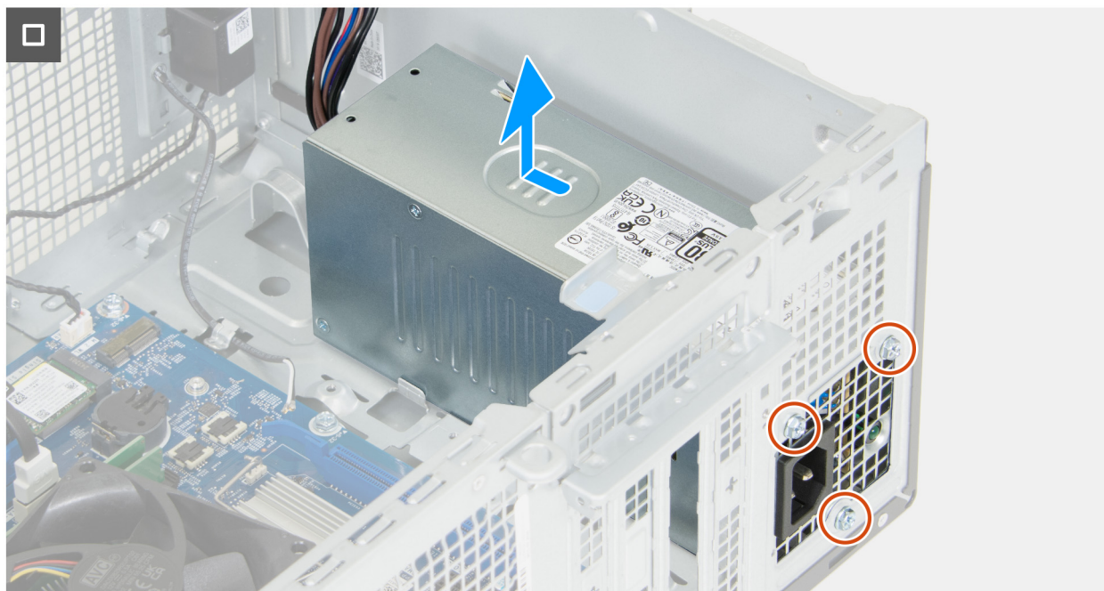
Obrázek 63. Demontáž napájecího zdroje
