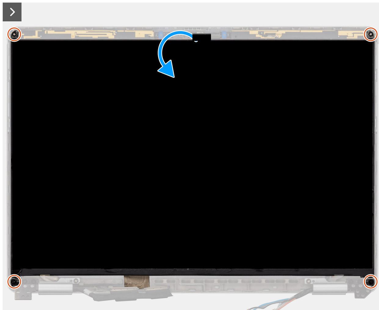
Obrázek 49. Demontáž obrazovky displeje
