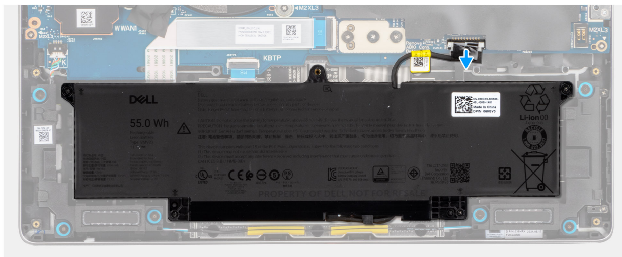
Obrázek 21. Odpojení kabelu baterie
