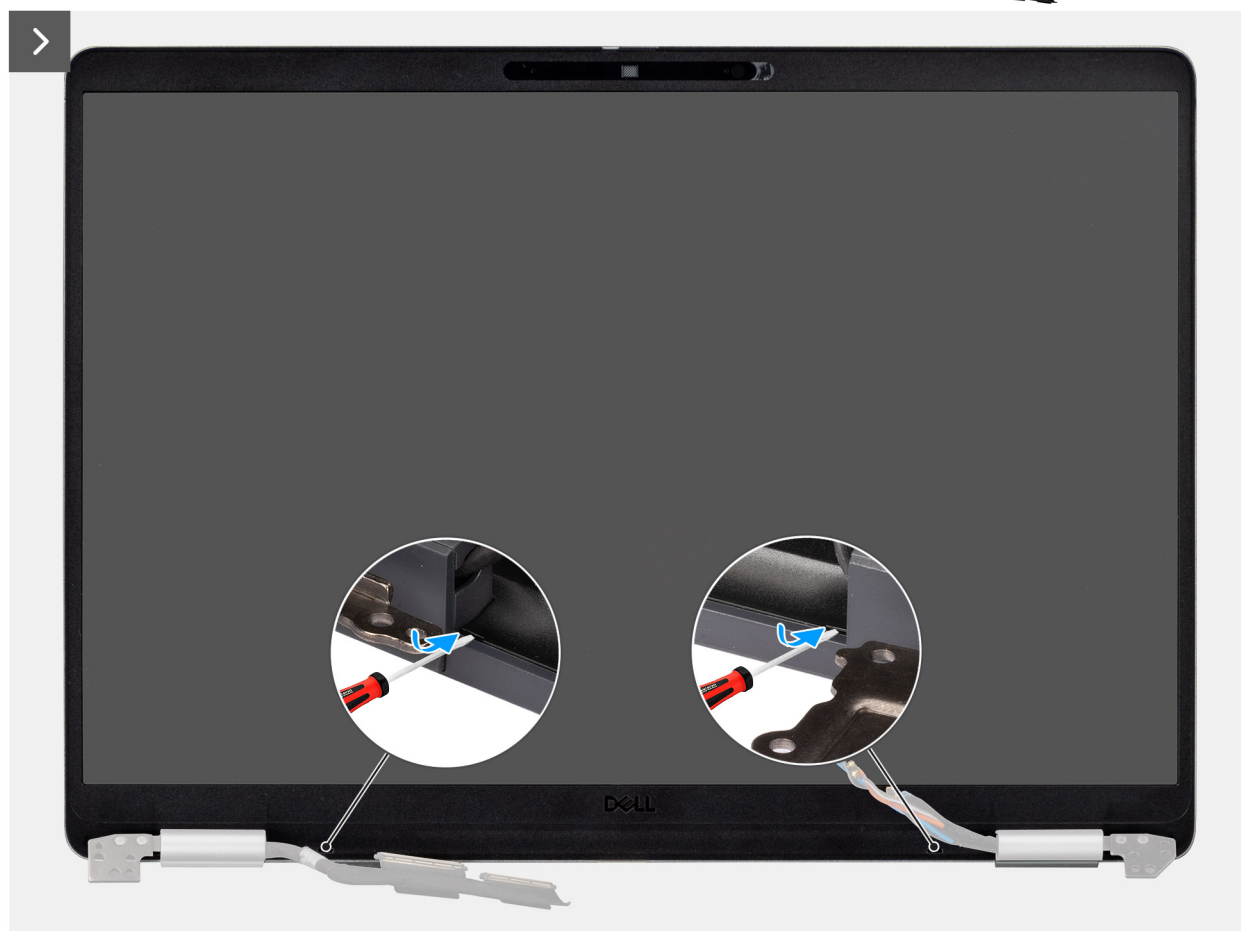
Obrázek 43. Uvolnění plastového čelního krytu
