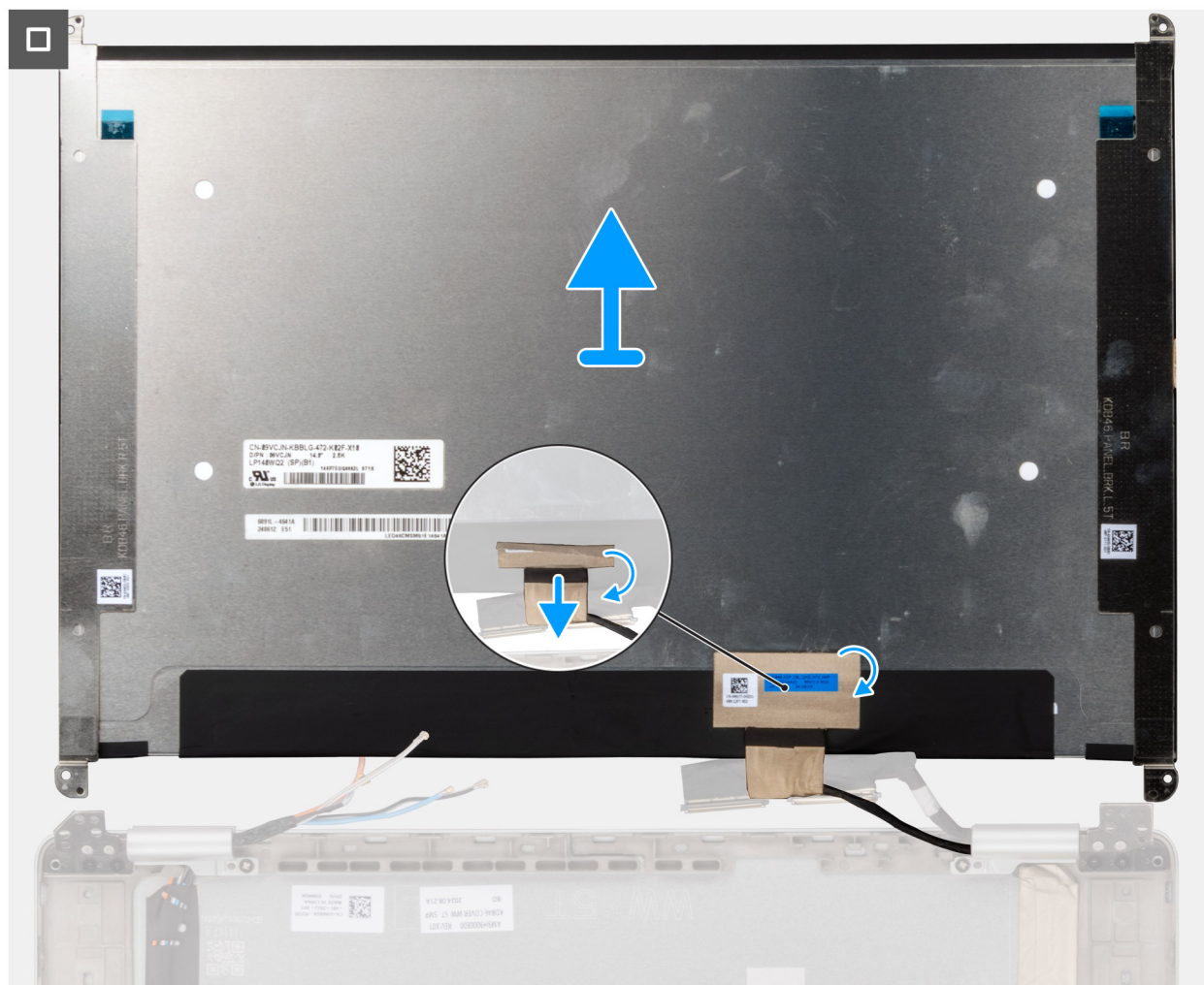
Obrázek 50. Demontáž kabelu displeje ze zadního krytu
