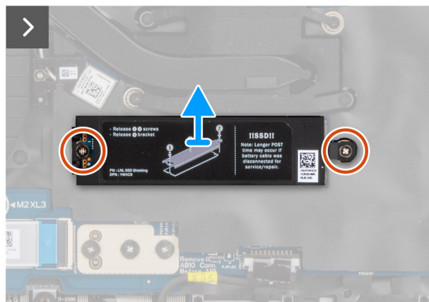
Obrázek 30. Demontáž disku SSD M.2 2230
